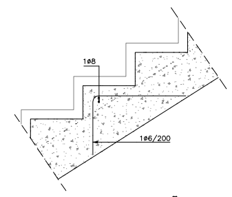
DETALLE DE PELDAÑO ESCALA 1:10
